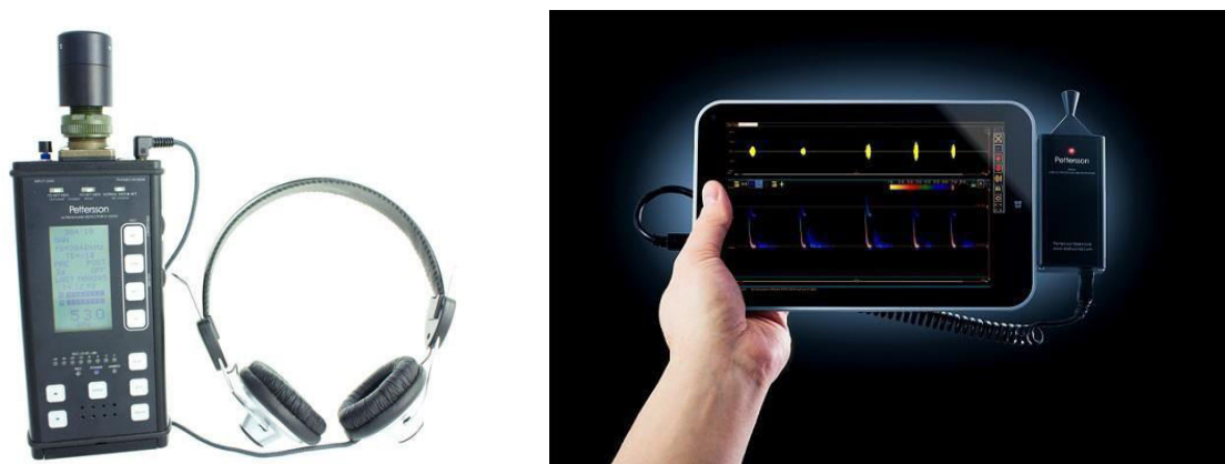
Figure 36. Détecteur ultrasons de chauves-souris, modèle : PETTERSSON (à gauche) et logiciel Batsound de Pettersson Electronic® (à droite)
